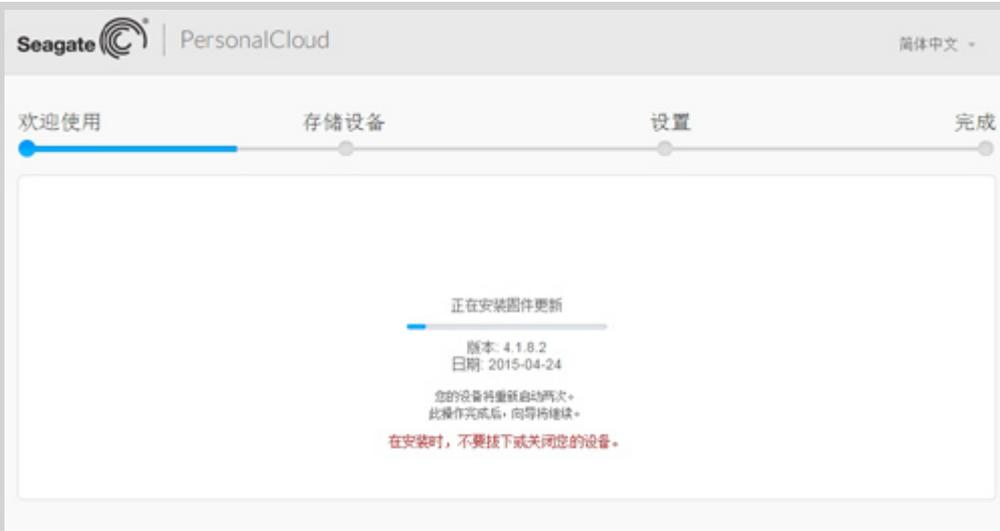
下载和安装最新固件大概要十多分钟, 固件更新完毕后, 进入到“存储”设置阶段, 2bay的可选择的设置有两个, RAID 1和RAID 0。
