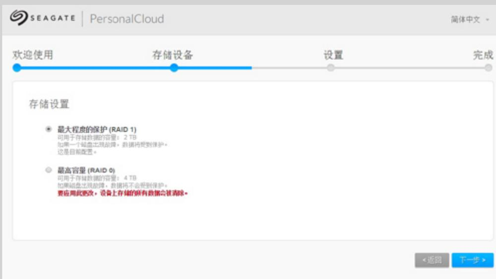
一般情况下说, 选择RAID 1可以将数据在两个硬盘上进行双机备份, 万一一个硬盘出现故障, 系统可以自动切换到另一个硬盘进行读写, 这使得数据的安全性和可靠性得到了很大的保障, 对于重要的数据建议使用RAID 1的方式保存。
